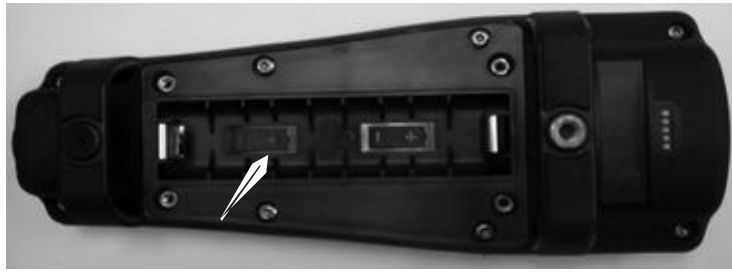
图 1.取出电池仓盖子的 Pro20. 请注意电池符号所指示的极性方向.
